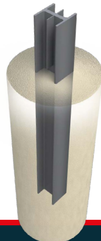
Опора с установкой в заранее пробуренную скважину
